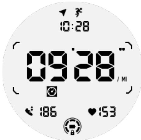
5. Geschwindigkeits-ULP-Kachel: Unterstützt sowohl imperiale (MI/H) als auch metrische (KM/H) Einheiten.
